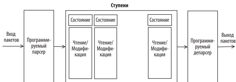
Илл. 5.44. Реконфигурируемый конвейер сопоставления действий для обеспечения программируемой плоскости данных
