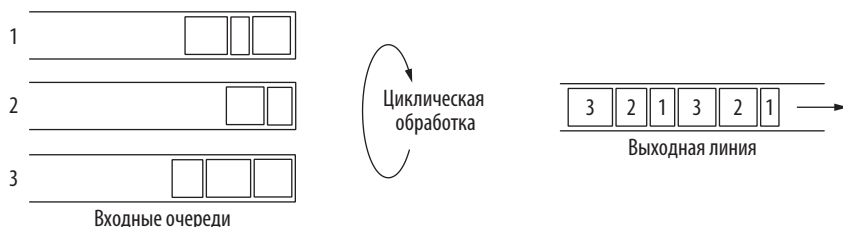
Илл. 5.28. Циклическая обработка равноправных очередей
