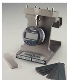
Пластины Алмена и приспособление для измерения их прогиба
