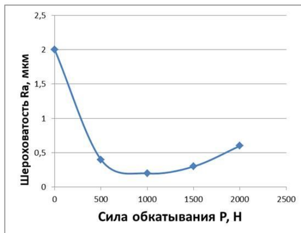
Зависимость шероховатости обработанной поверхности от усилия обкатывания при обработке роликом R20 мм стали 45
