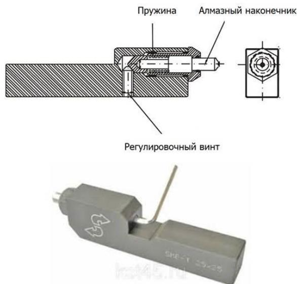
Конструкции державок для алмазного выглаживания различны. Наиболее просты конструкции для жесткого выглаживания и для упругого с тарированной пружиной. Такие державки не занимают много места в инструментальном магазине и легко настраиваются. Основной их недостаток – они не позволяют оценить величину изменения усилия или натяга в процессе обработки, а значит точно ее контролировать.
