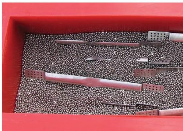
Вибрационная ударная обработка по схеме “в навал”
