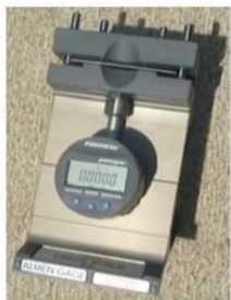
Индикаторное приспособление для измерения прогиба контрольных пластин из алюминиевого сплава с удержанием пластины механическим методом (TSP-3AAA)
