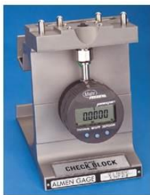
Индикаторное приспособление для измерения прогиба стальных контрольных пластин с удержанием пластины магнитом (TSP-3)
