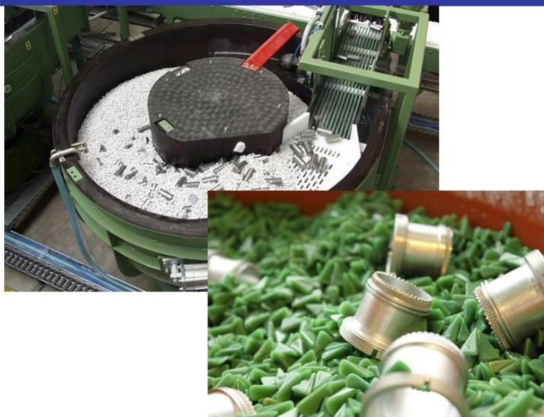
Обработка мелких деталей в установке кругового типа
