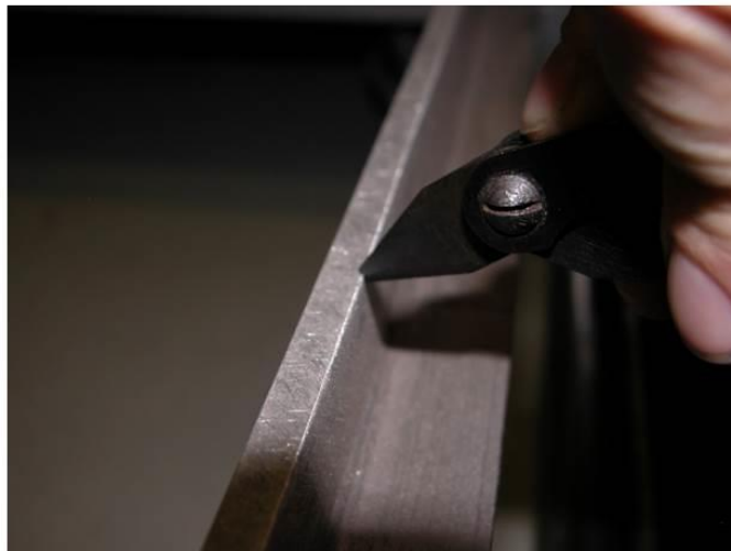
Контроль результата (радиуса скругления кромки) в производственных условиях обработки радиусным шаблоном
