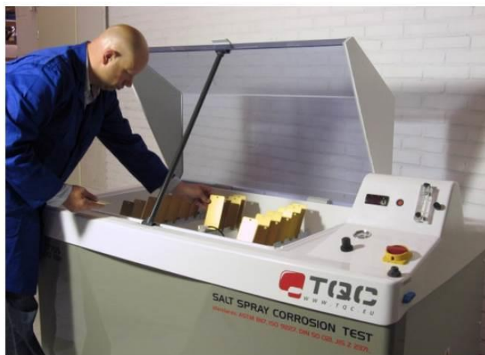
Подготовка обработанных образцов к коррозионным испытаниям в камере соляного тумана
