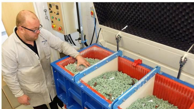
Разделение рабочего пространства контейнера для последовательной обработки рабочими телами различной зернистости
