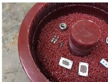
Обработка мелких деталей в установке кругового типа
