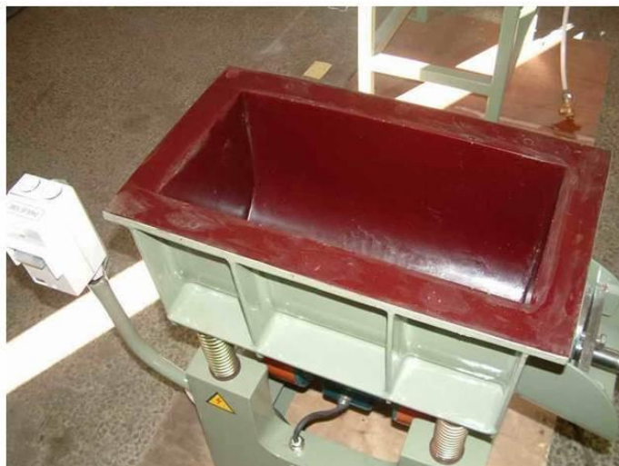
U-образная форма дна контейнера установки лоткового типа
