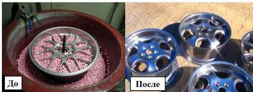
Результат последовательной обработки абразивными гранулами различной зернистости
