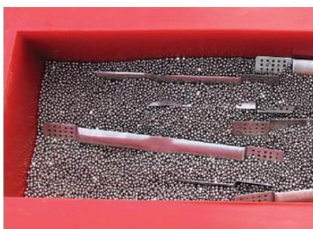
Обработка протяжённых деталей в установке лоткового типа
