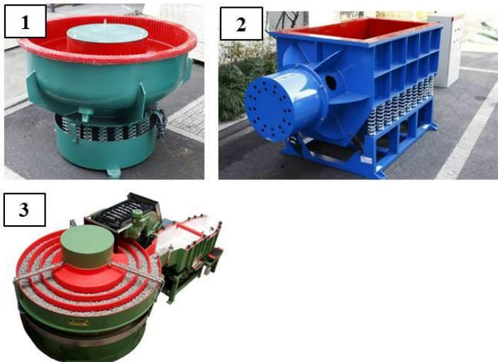
Установка кругового (тороидального) (1), лоткового (цилиндрического) (2) и спирального (3) типа
