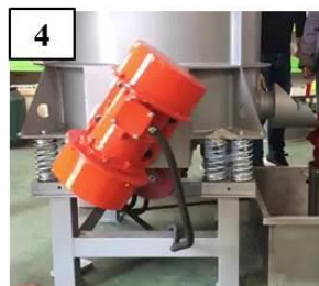
Типовые исполнения дебалансных виброприводов (1-3) и пример монтажа вибропривода на контейнер (4)
