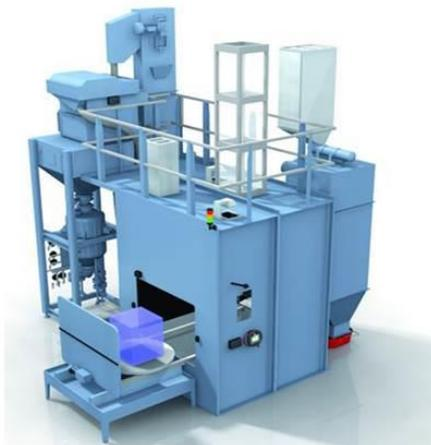
Дробеструйная установка с поворотным столом
