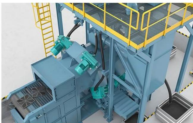
Дробебетная установка ленточным сетчатым конвейером
