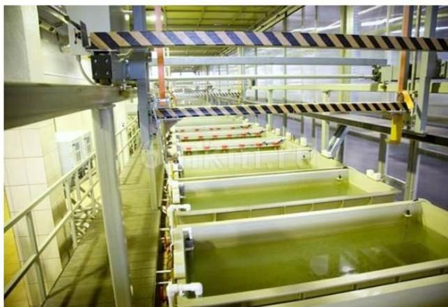
Химическую обработку деталей с целью удаления следов железа с их поверхности следует начинать не позднее 10 суток прошедших после начала выполнения операции упрочнения.
