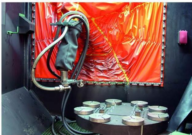
Дробеструйная установка с поворотным столом
