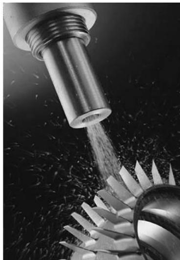
Дробеударная упрочняющая обработка представляет собой процесс поверхностного пластического деформирования рабочими телами в виде стальной, чугунной, керамической дроби различных размеров, происходящий при ударном взаимодействии дроби с поверхностью обрабатываемой детали. Дробь направляется на обрабатываемую деталь в виде потока (потоков), с заданной скоростью и в определённом направлении.
