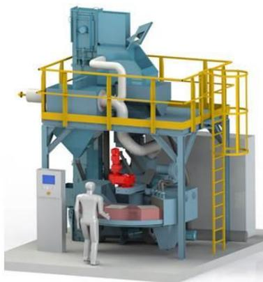
Дробеударная установка с поворотным столом
